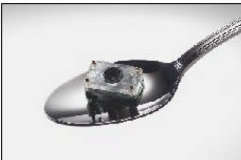
IT40XXは、CMOSイメージセンサを使用した世界最小のイメージエンジンです。バーコード、二次元シンボル、合成シンボル、郵便バーコード、OCR-A/Bの読取ができるイメージエンジンモジュールです。
